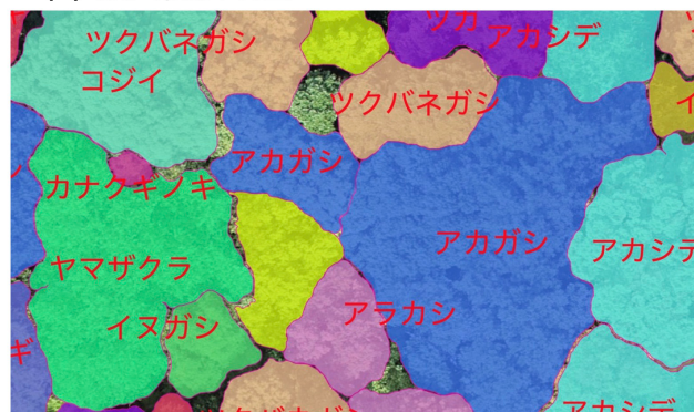
図2 調査地の一例。(a)広域のオルソ画像と (b) 個体分離した樹冠地図。それぞれの樹冠に関しては樹高や樹冠面積の情報が自動計算される。(c) 拡大したオルソ画像と (d) 拡大した樹冠地図。
